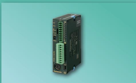
Il **PLC FP0R** è caratterizzato da dimensioni ultracompatte, offre elevata velocità di elaborazione (80ns per istruzione base), ampia capacità di programma 16k o 32k passi e funzioni di alto livello. Grazie alla possibilità di pilotare direttamente sino a 4 assi a bordo cpu (modello a transistor), di leggere sei canali HSC, FP0R è ideale per semplici applicazioni di posizionamento e di controllo della velocità.
